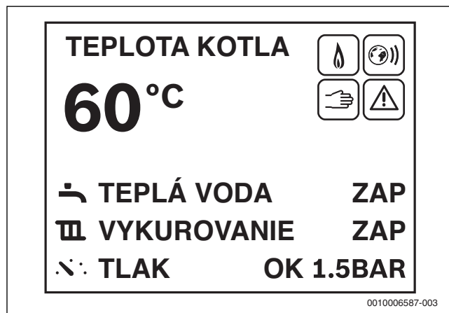
Obr. 5 Štandardné zobrazenie prevádzkového tlaku vykurovania
